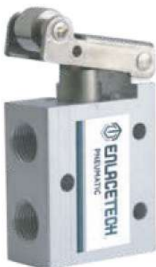
431 MR 3/2 1/8" Válvula Neumática de Rodillo - retorno por resorte
